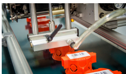
Aplikacja etykiet w sposób pneumatyczny
